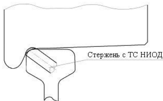
Рис. 2. Схема нанесения ТС НИОД на гребни колесных пар
