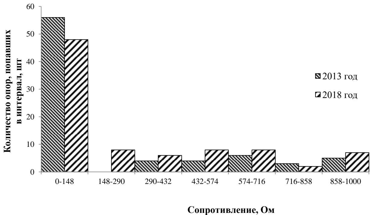
Рисунок 3.2 – Распределение сопротивлений опор контактной сети в 2013 и 2018 годах в интервале до 1000 Ом
