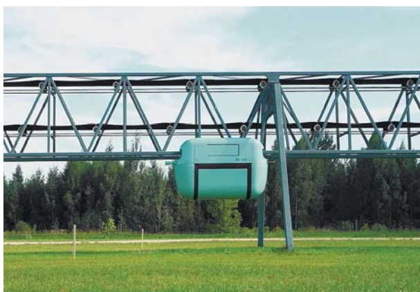
Рис. 3. Грузовое транспортное средство SkyWay — юнитрак
