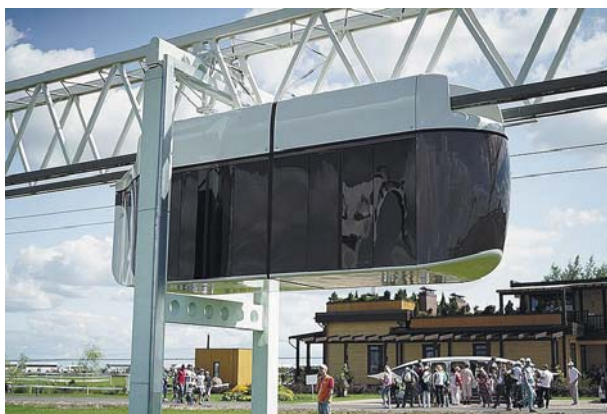
Рис. 1. Городское пассажирское транспортное средство SkyWay — подвесной квадирельсовый 48-местный юнибус. Марьина Горка, 2019 г.
