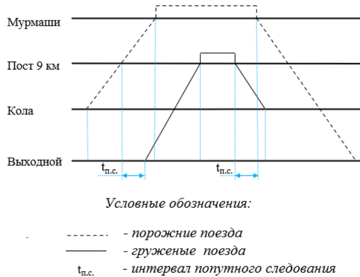
Рисунок 2.12 – Схема организации движения на участке Выходной – Мурманши – Кола (фрагмент графика движения поездов)
