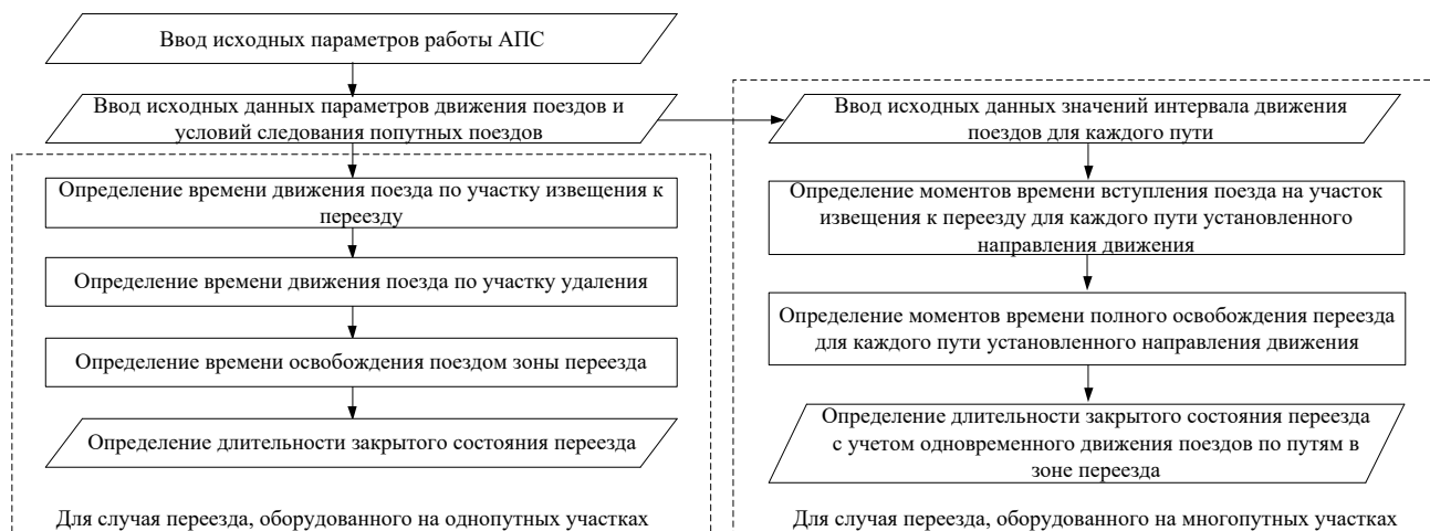
Рисунок 2.4 – Структура схемы, описывающая процесс определения длительности закрытого состояния переезда на однопутных и многопутных участках
